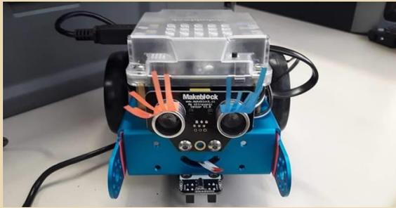
Une fois le programme testé, il est possible de le téléverser dans la carte Arduino du MBOT par câble USB
